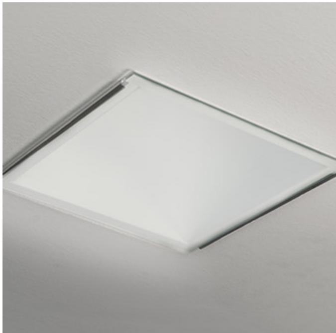
Corpo illuminanti a LED tipo 3F-Filippi LUCEQUADRO LED VS o similare in acciaio verniciato, dissipatore passivo in alluminio, schermo in vetro stampato, dim. indicative 235x235xh116 mm, IP20/44. Cablaggio elettronico, sorgente LED 27W, 4000 °K, flusso luminoso in uscita lm 2894
